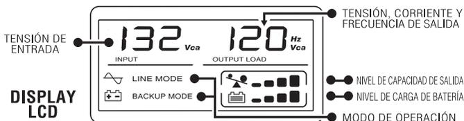
**4. ALARMA AUDIBLE DE BATERÍA EN OPERACIÓN Y BATERÍA BAJA REEMPLAZAR.** Si la línea comercial falla o es inferior a 85 V~ o mayor a 145 V~; el equipo produce un tono audible intermitente para indicar que esta operando con batería. Para indicar el apagado inminente del inversor por haberse agotado la reserva de la batería, el tono audible se volverá continuo durante los últimos minutos.
